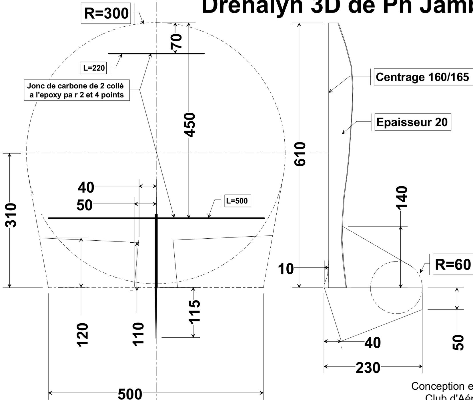
Coordonnées de construction du fuselage
